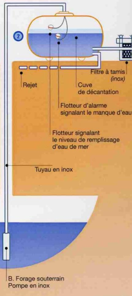
Installation dans la roche d'une pompe en inox, pour le prélèvement d'eau de mer
